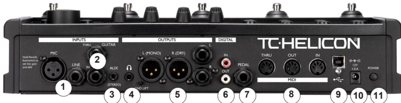
1. INPUTS – Buchsen MIC und LINE: Schließen Sie hier Ihr Mikrofon oder ein Audiogerät mit Linepegel an. Es sollte nur ein Mikrofon oder ein Line-Audiogerät angeschlossen sein. Um den Eingangspiegel (Gain) anzupassen, wenn Sie zwischen Mikrofon und Line-Eingängen wechseln, drücken und halten Sie den Taster REVERB.
