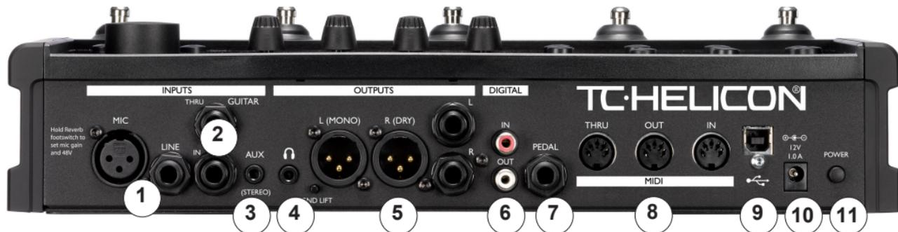
1. Entradas MIC y LINE - Conecte aquí su micrófono o salida de dispositivo audio de nivel de línea. Solo puede conectar uno de ellos a la vez. Mantenga pulsado el interruptor REVERB para ajustar la ganancia cuando cambie entre las entradas MIC y LINE.
