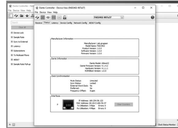
有关 Dante 网络同步的信息,请从默认路由视图转到时钟状态选项卡。该视图将显示网络中设备的内部时钟是否同步,并显示 FAD 单元的主/从状态。设备的主/从状态也可以在 FAD 单元的后面板上看到,其中 CLOCK SYNC LED 的持续绿灯表示 FAD 单元是网络中另一个单元的从属,闪烁的绿灯表示 FAD 单元是网络中的 Master。
