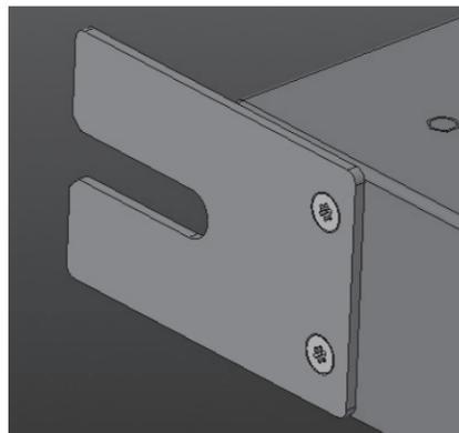
通过前角支架和机架导轨连接 4 个机架螺钉,将 FAD 单元安装到机架中。
