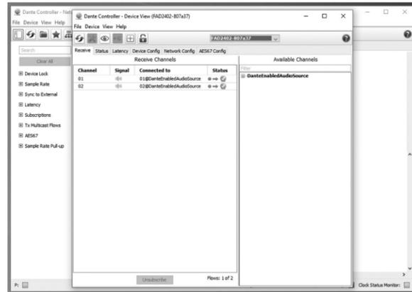
6. 设备配置选项卡允许更改 FAD 单元的音频设置。请注意,对音频编码 (采样率、位深度等) 所做的更改必须与启用 Dante 的音频源设备的设置相匹配,不匹配将破坏信号链并保持订阅,直到配置匹配为止再次。
