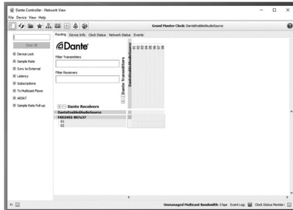
4. 突出显示 FAD Dante 通道之一和启用 Dante 的音频源通道之一之间的交叉点,然后左键单击鼠标。成功订阅将显示为绿色复选标记。如果您无法创建订阅或遇到红色“否”符号,则 FAD 和启用 Dante 的音频源设备之间可能存在配置不匹配 (例如采样率、位深度等)。配置启用 Dante 的音频源设备以匹配 FAD 设备的默认 Dante 音频配置,或配置 FAD 设备以匹配步骤 6 中对话框中启用 Dante 的音频源设备设置。
