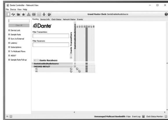
5. 要显示设备状态并更改 FAD 的配置,请在同一视图中双击设备名称。此窗口允许用户更改频道标签、设置编辑设置限制以及识别物理设备。按下“识别设备”按钮将触发 FAD 单元后面板上的 IDENTIFY LED 闪烁。
