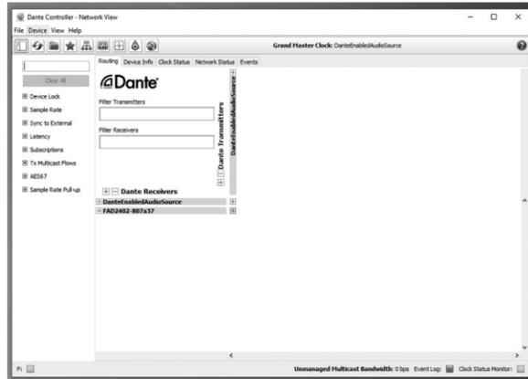
3. 要与网络中的 Dante Transmitter 建立连接,请单击设备名称左侧的加号展开 FAD Dante 通道列表。通过单击启用 Dante 的音频源设备名称下方的加号,在 Dante Transmitter 通道列表中展开首选的启用 Dante 的音频源。
