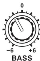
**注意:** モニター・ミックスにドラムを返す場合、キックドラムの低域を、ブーストよりもカットする方向で、控えめにイコライジングします。
