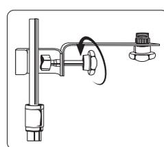
マウンティング・プレートにエクステンション・ブラケットを取付ける
