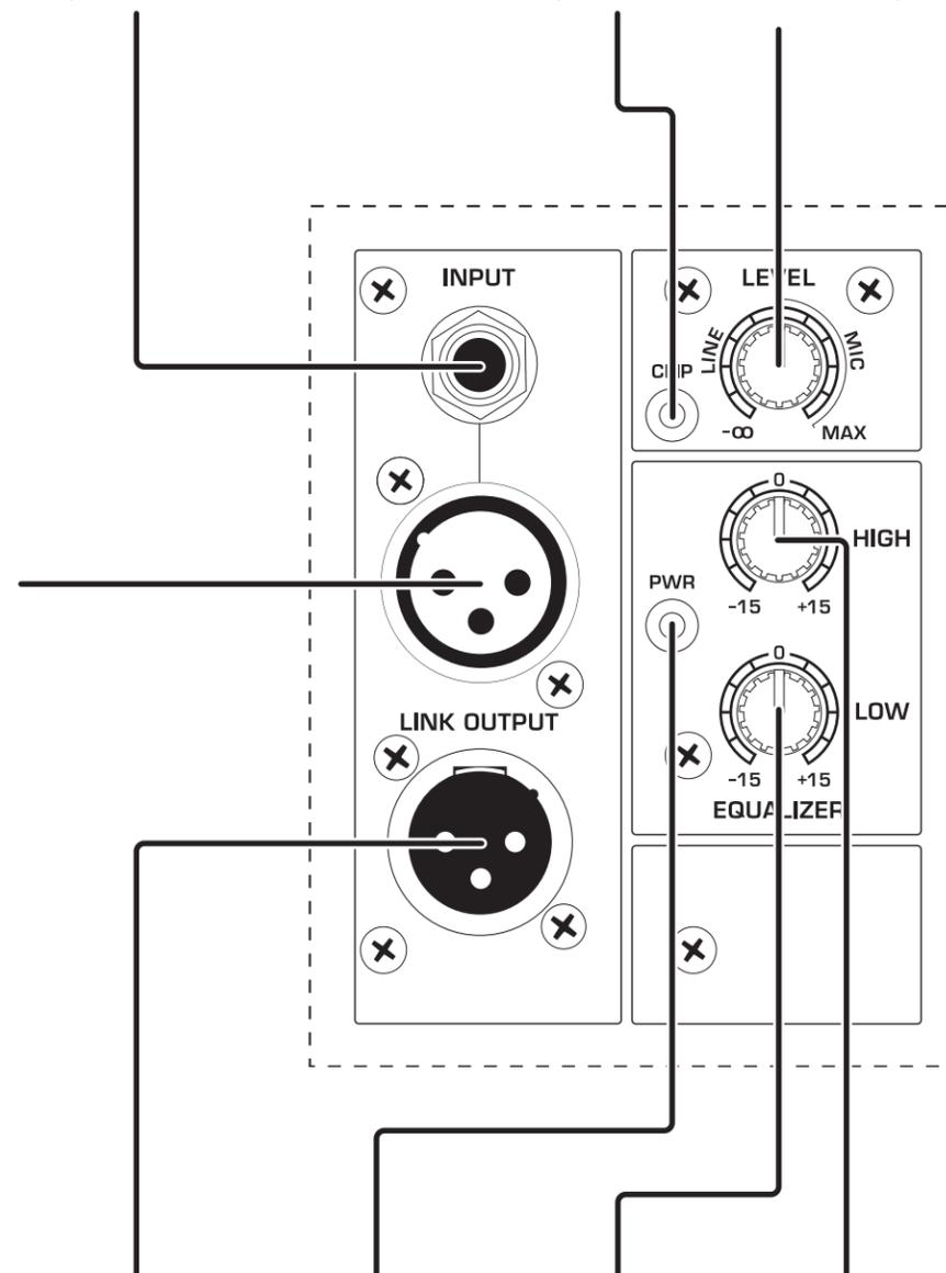
**LINK OUTPUT** XLR ケーブルを使って、信号ソースのコピーをもう1台のスピーカーに送ります。
