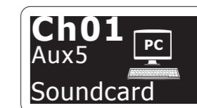
Ejemplo: El canal 1 tiene el apodo 'Soundcard' y recibe la señal desde la entrada auxiliar 5
