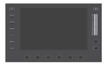
WING 的大多数控件都可以通过 10 英寸触摸屏主显示屏进 行编辑和监听。可以使用屏幕左侧的 7 个按钮以及位于顶 部面板每个主要部分的 VIEW 按钮来访问各种屏幕。
