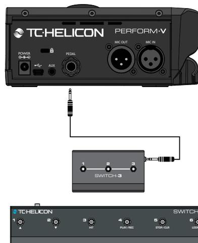
Connexion d'un Switch-3 ou Switch-6 à l'entrée pédale du Perform-V
