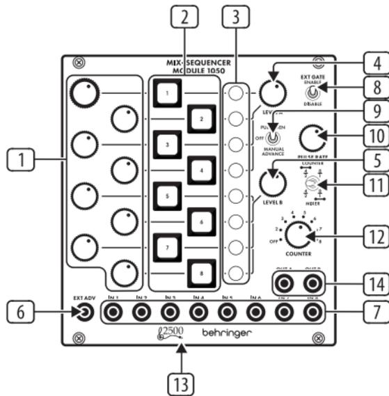
1 **通道电平旋钮** - 每个旋钮控制其各自混音通道的混音电平, 旋钮按颜色编码为两组四个通道, 以使用电平 A (LEVEL A) 和电平 B (LEVEL B) 旋钮进行进一步分混音。
