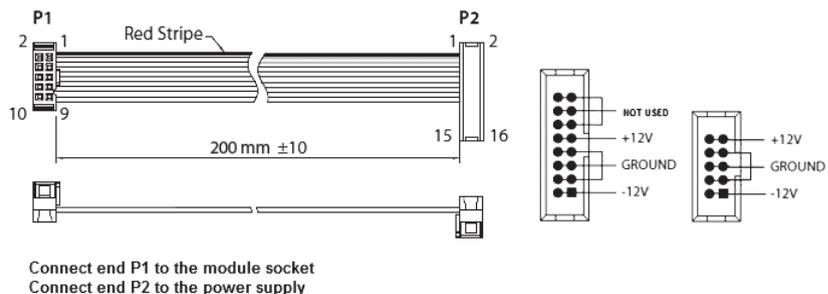
该模块随附所需的电源线，用于连接到标准 Eurorack 电源系统。请按照以下步骤将电源连接到模块。在将模块安装到机架盒中之前，进行这些连接会更容易。
