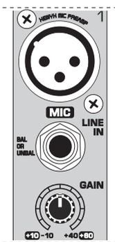
Fig. 2.1: Connecteurs et potentiomètre des entrées micro/ligne
