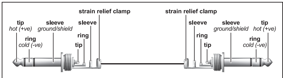
図 4.3: 6.3 mm TRS ステレオフォンジャック
