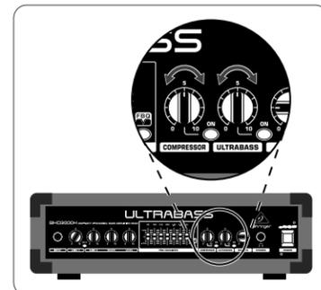
**11** 旋转 MASTER 旋钮, 调节输出音量。
