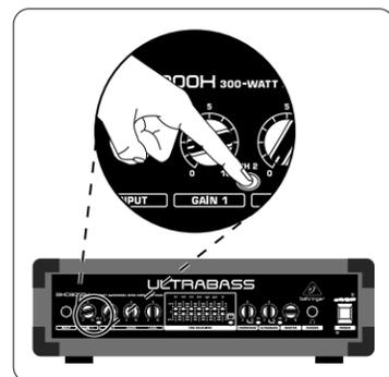
**7** 调节 GAIN 2, SHAPE 和 LEVEL 旋钮, 改变通道 2 的音色。
