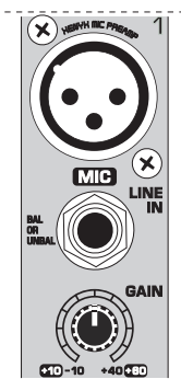
Εικ. 2.1: Συνδέσεις και ρυθμιστές των εισόδων Mic/Line
