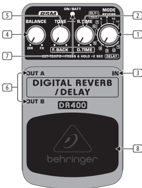
Usando entrambi i connettori si ottiene un effetto completamente stereo. Per l'uso in mono collegare soltanto OUT A.
