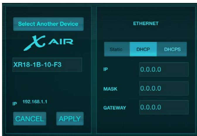
Nome do mixer e tela de configuração Ethernet
